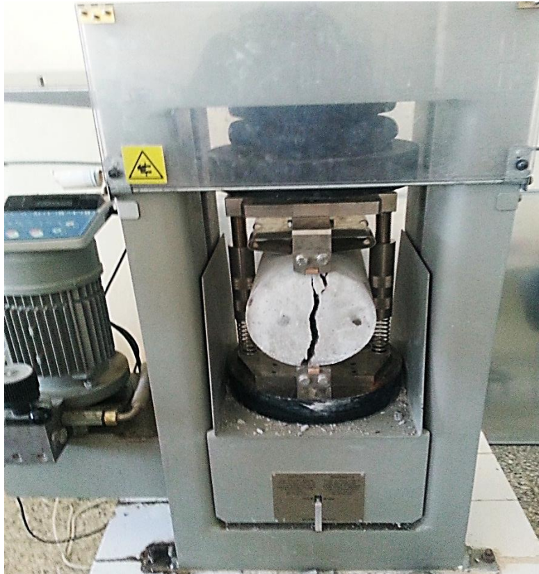
Figure II. 7. Essai de traction par fendage (essai brésilien).
