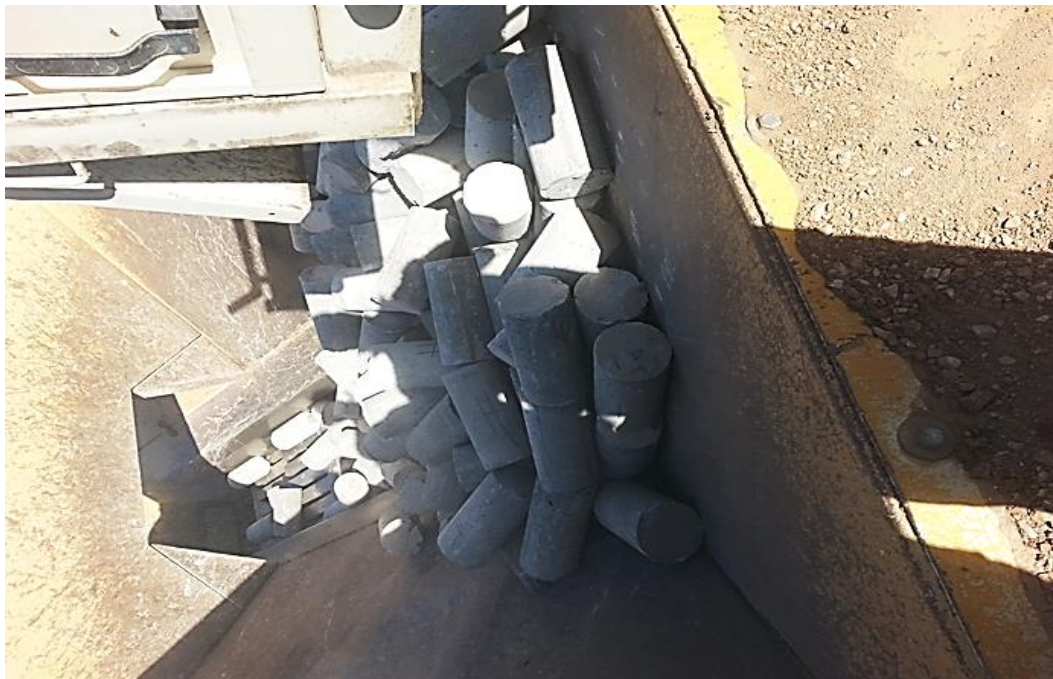
Figure II. 3. Éprouvettes utilisées pour l'obtention du gravier recyclé.
