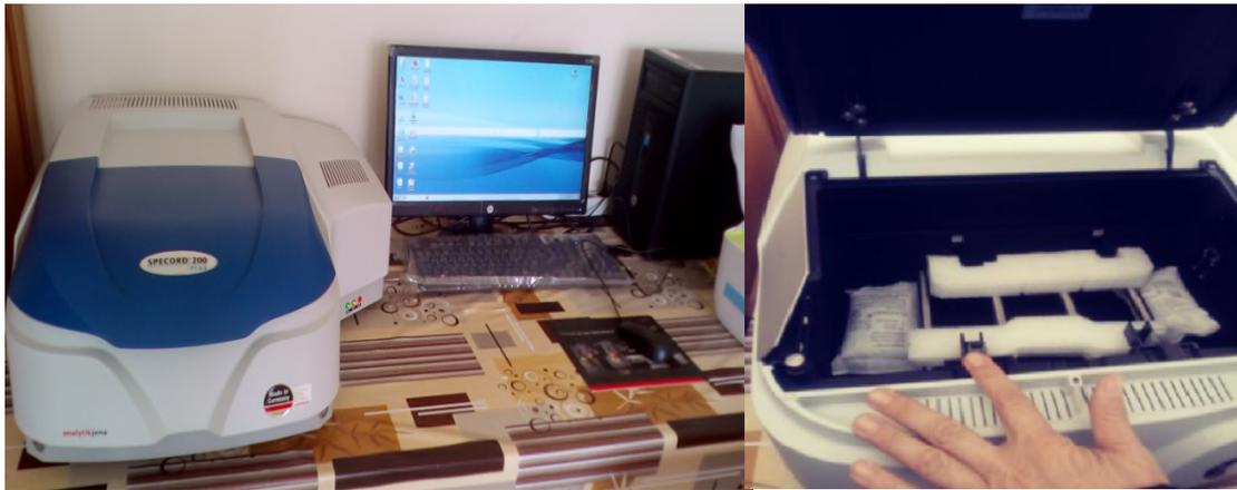
**Figure II.5 :** Spectrophotomètre de type SPECORD 200 PLUS du laboratoire de physique, département de physique, Université de Bejaia.
