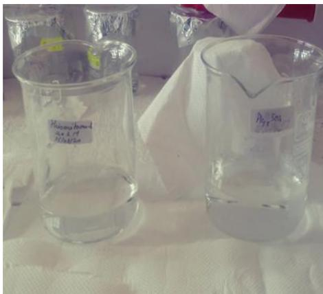
**Figure II.2** : Solutions mères de sulfate d'argent et de thioacétamide de concentration 0.01M.
