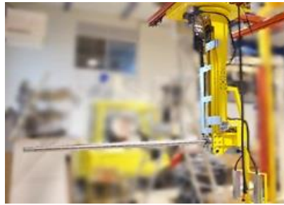
Figure I.4 : un outil de prise avec poignée longue [1]
