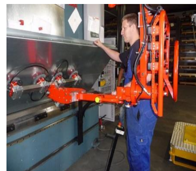
Figure I.1.c: Manutention d'une tôle pour le pliage[2]
