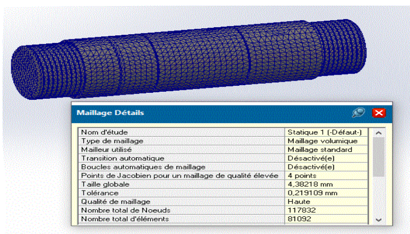
Figure IV.57 : Génération de Maillage volumique d'axe d'articulation.
