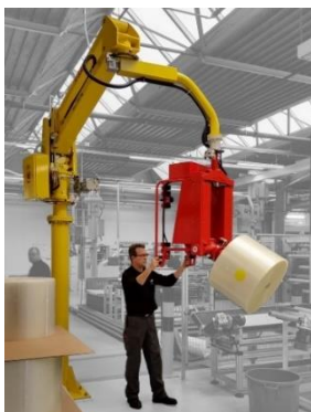
Figure I.1.a : Manutention d'une bobine de forme cylindrique[1]
