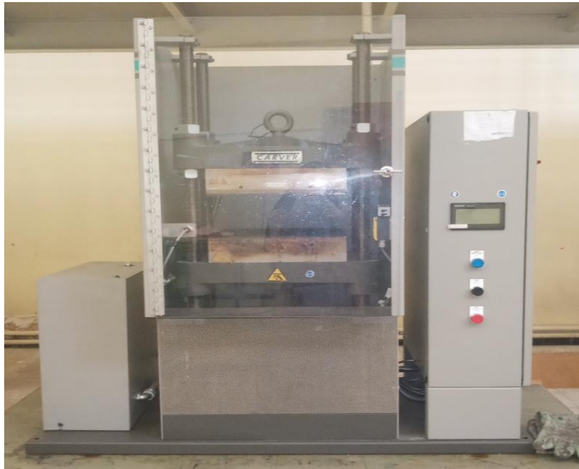
Figure III.8 : Presse hydraulique du type Carver, effectuée au sein du laboratoire Hall des Polymères à l'université de Ferhat Abbas-Sétif 1.
