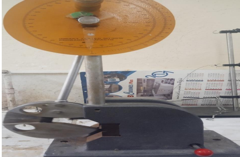
Figure III.10 : Appareils d'essai Charpy de type Ceast, réalisés au Hall technologie de l'université de Bejaia.
