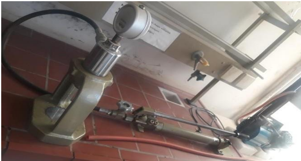
Figure III.6 : Pastilleuse manuelle type Shimadzu, au niveau du laboratoire génie desprocédés à l'université de Bejaïa.
