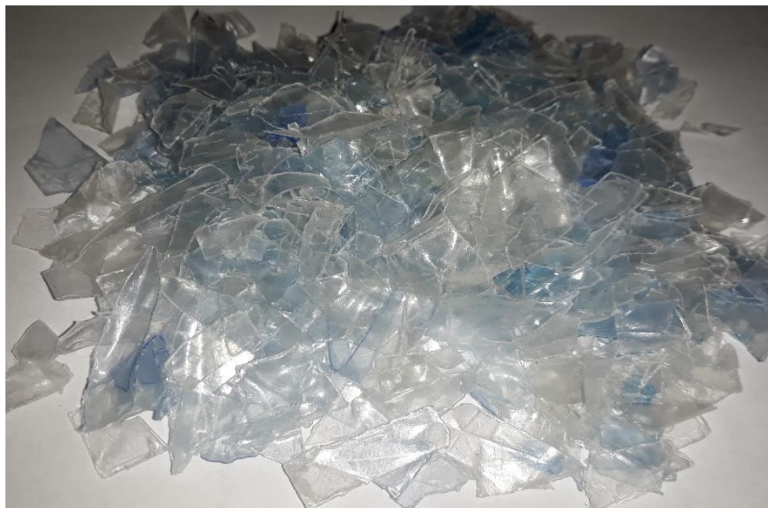
Figure III.3 : Le PET recyclé (PETr) utilisé sous forme de paillette, fourni par l'entreprise Revaplast.
