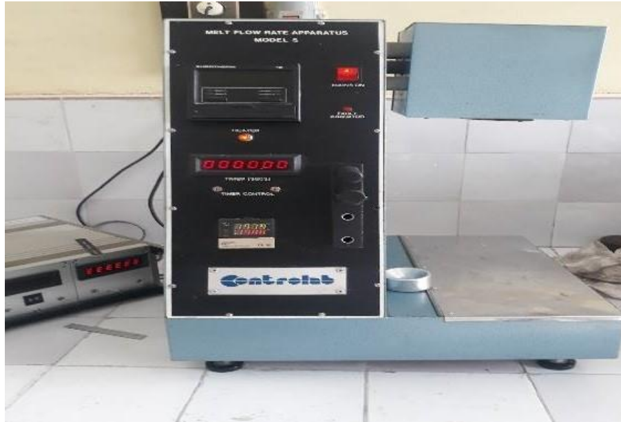
Figure III.9 : Appareil de mesure de l'indice de fluidité (IF), réalisés au Hall des Polymères à l'université de Ferhat Abbas-Sétif 1.
