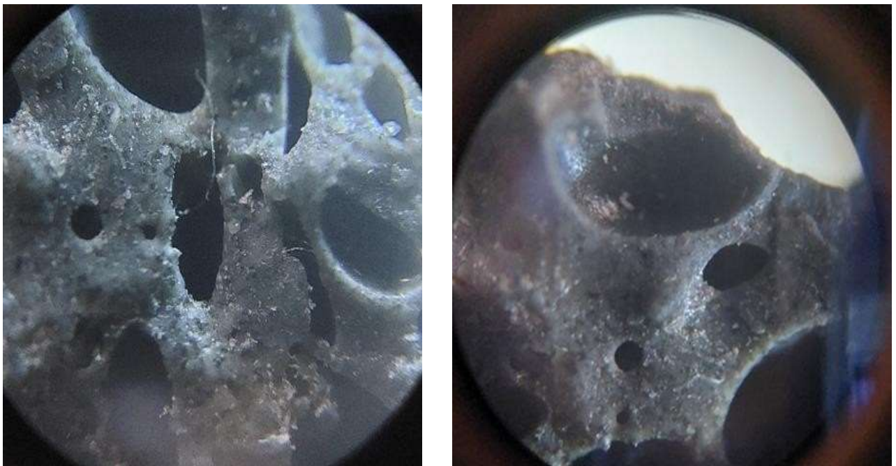
Figure IV.11: la fracture d'une éprouvette de mélange industriel (70%PETr/30%PEHDr)
