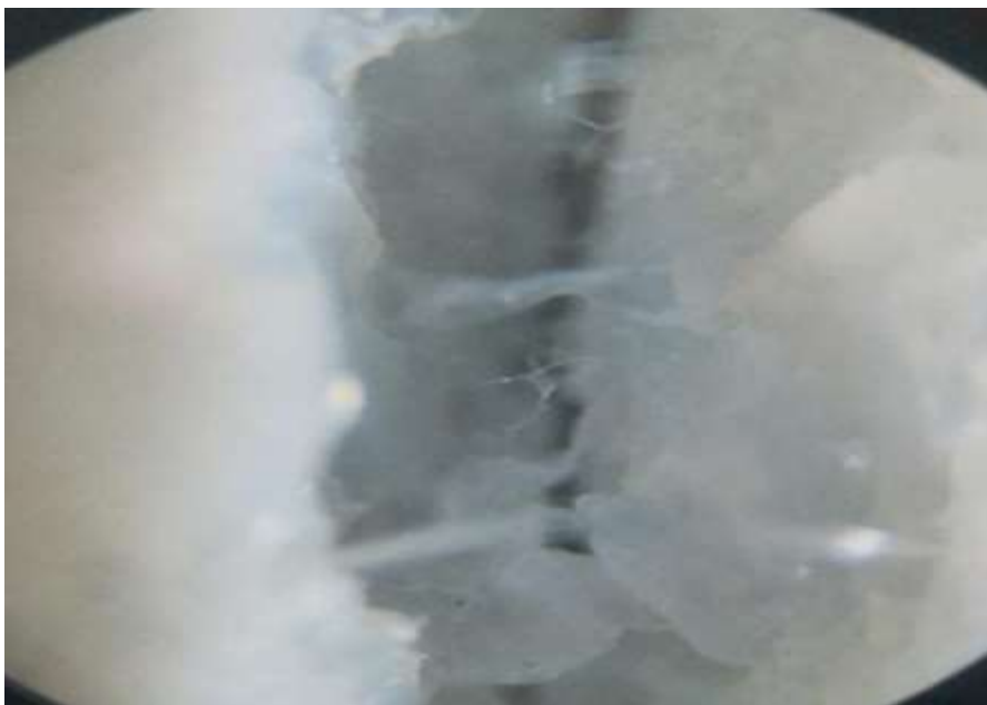
Figure IV.8: la fracture d'une éprouvette du mélange (80%PETr/20%PEHDr)
