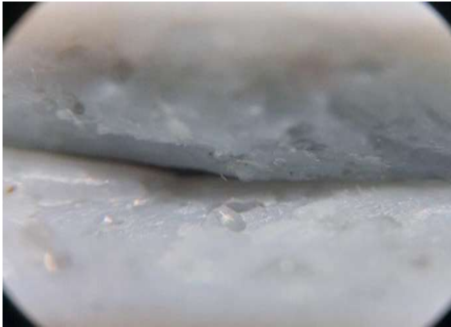
Figure IV.7 : la fracture d'une éprouvette du mélange (90%PETr/10%PEHDr)
