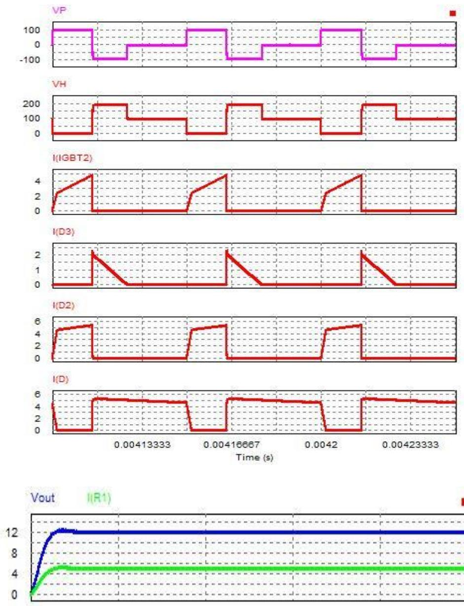
Figure II. 5 : formes d'onde en régime permanent d'une alimentation FORWARD
