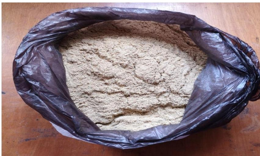
**Figure III.1** : Le sous-produit de kaolin (sable G0).
