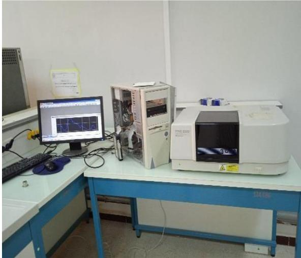
**Figure III.5.**Appareil d'analyse d'infrarouge.
