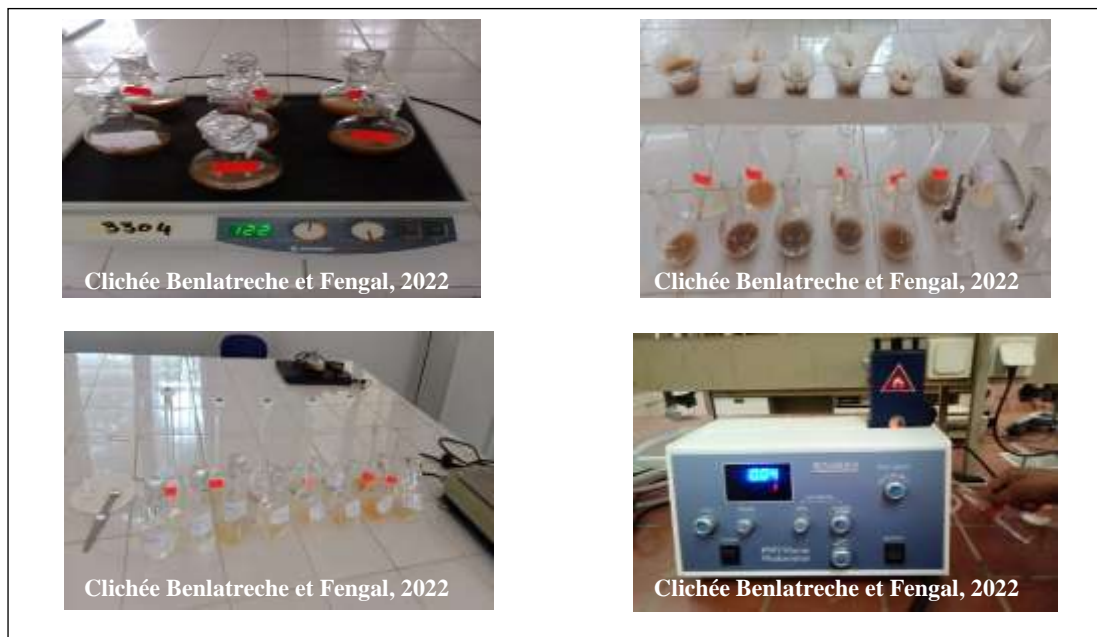
Figure 13: Etapes de dosage du Potassium assimilable dans le sol (Photographie originale, 2022).
