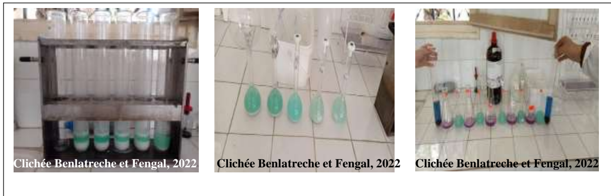
Figure 14 : Etapes de dosage de l'azote total dans le sol (Photographie originale, 2022).
