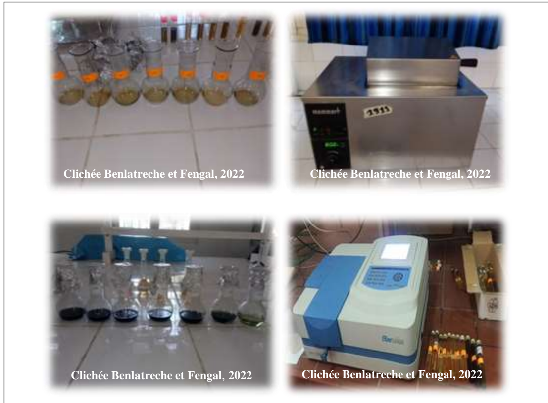
Figure12 : Etapes de dosage du phosphore assimilable dans le sol ( Photographie originale, 2022 ).
