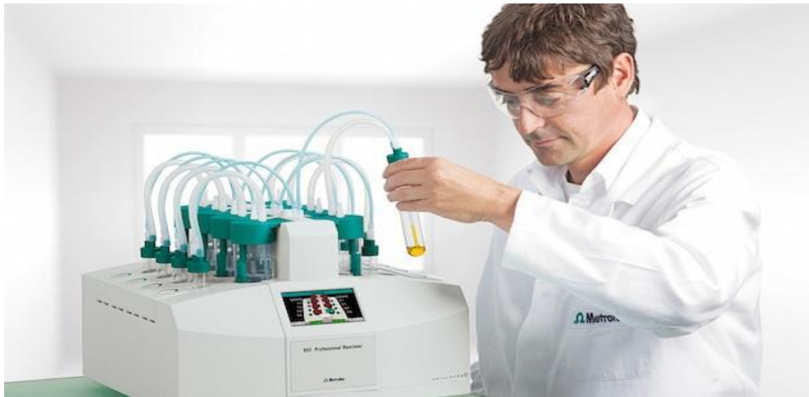
Figure III.1: Système de mesure de stabilité oxydative (test de Rancimat)
