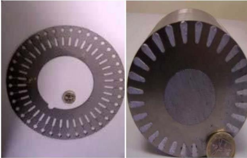
Figure I.4. Circuit magnétique constituant le rotor à cage d'écureuil [33]
