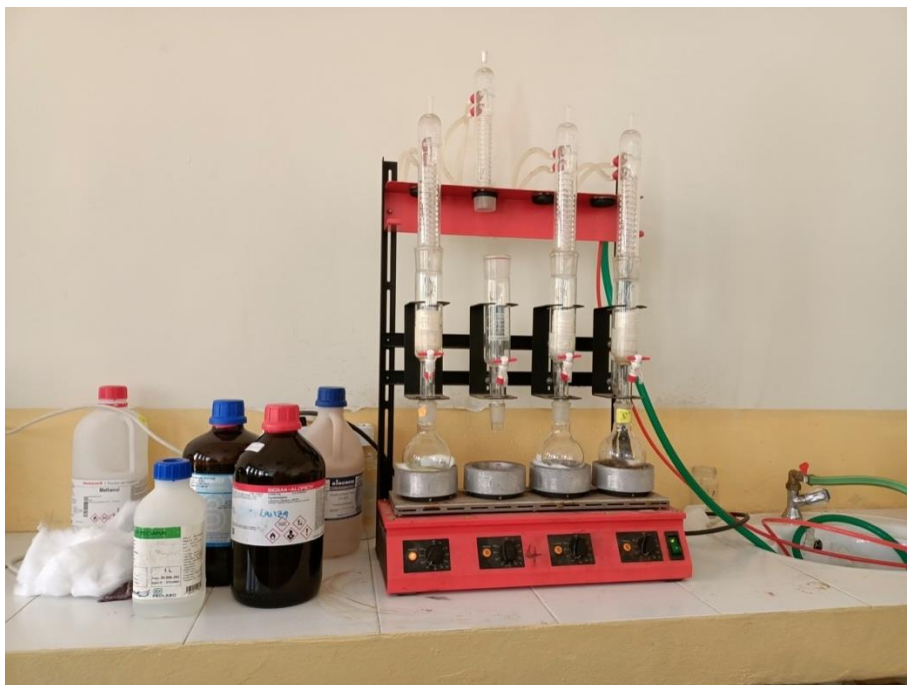
Figure 6. Extraction des HAP par l'appareil Soxhlet (model : behrotest)
