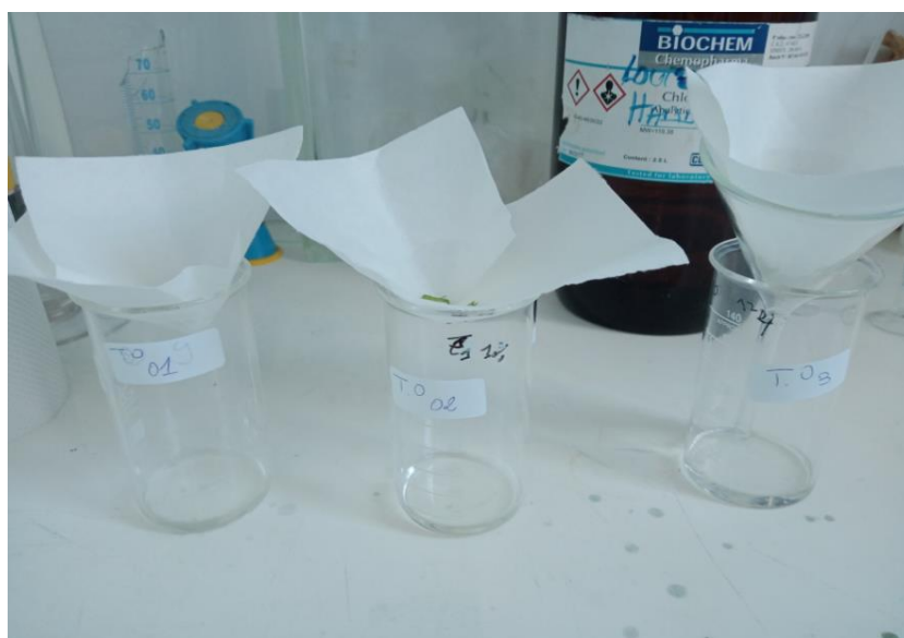
Figure 8. Extraction de la poussière et de cire de Brassica oleracea par chloroforme
