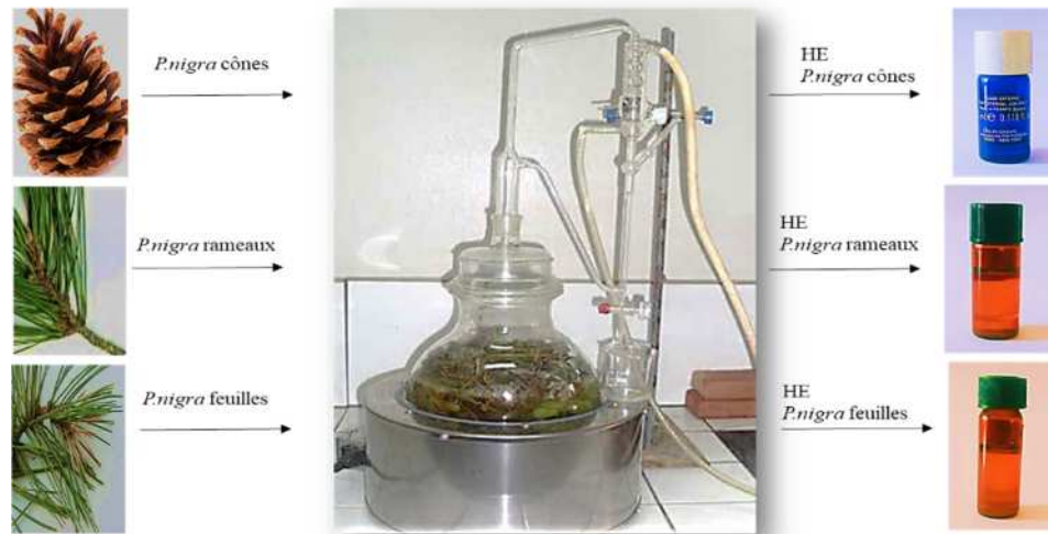
Figure 4 : Extraction des huiles essentielles des différentes parties de P. nigra par hydrodistillation
