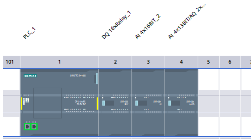
Figure III.6: La CPU S7 1215FC et les modules d'extensions sur logiciel TIA Portal.
