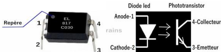
Figure II.18: architecture d'un opto-coupleur (emetteur-recepteur).
