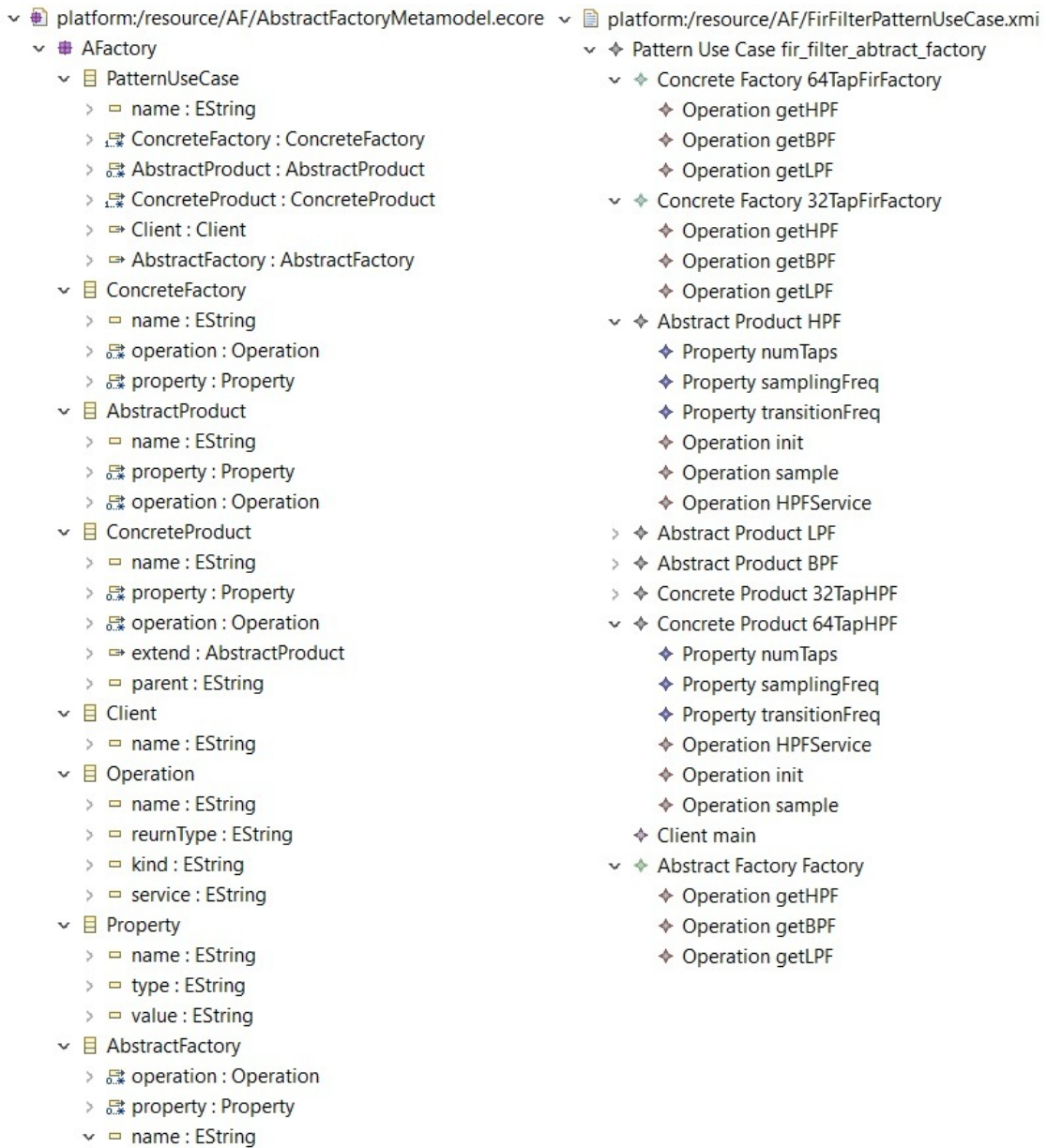
FIGURE 5.13 – Le métamodèle de l'Abstract Factory (à gauche) et le modèle instancié du filtre FIR (à droite).
