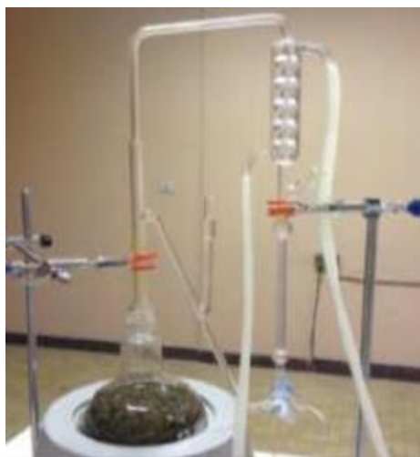
Figure 12 : Dispositif d'hydrodistillation (type Clevenger) utilisé pour l'obtention des huiles essentielles (Yasmine MESSARA 2018)
