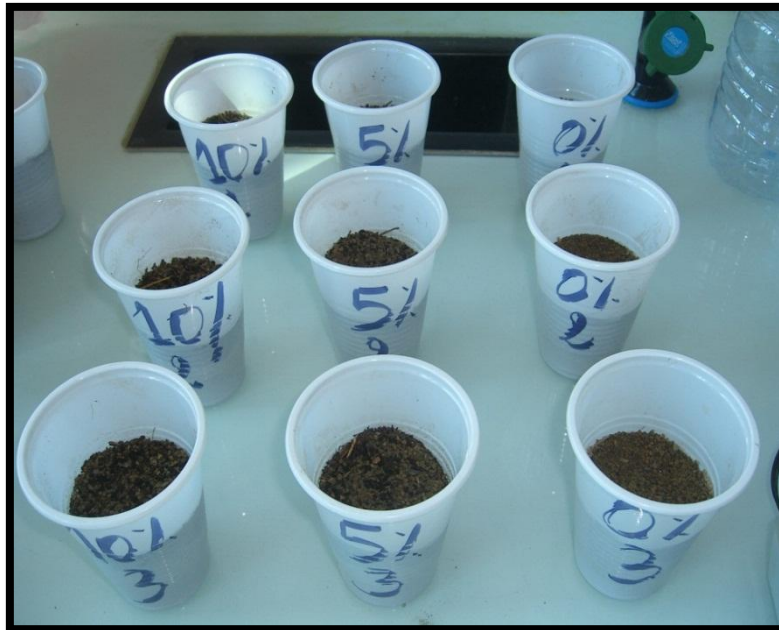
Figure n°16 : Mélange terre-matières organique à différentes doses et à 3 répétitions
