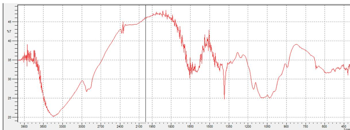
**Figure IV.2:** Spectre infrarouge du Chitosane dans KBr
