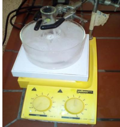
Plaque d'agitation magnétique avec chauffage utilisée
