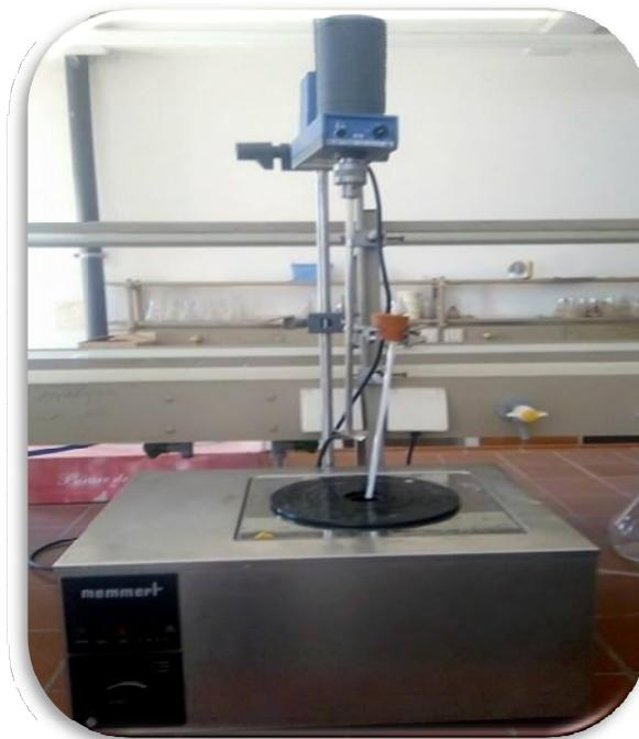
Dispositif utilisé pour la dissolution des microparticules
