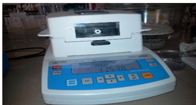
Figure n°5: Photo du dessiccateur de type (RADWAG 50/ NP)
