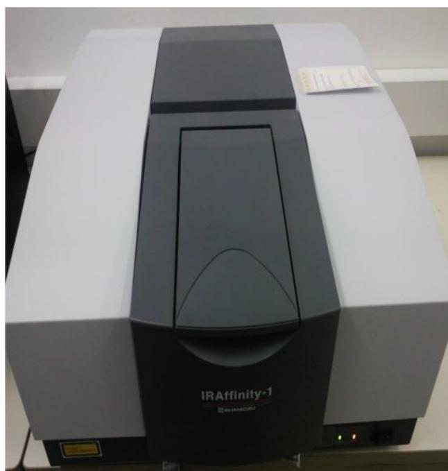
**Figure n°3 :** Photo du spectromètre IR Affinity-1 FTIR
