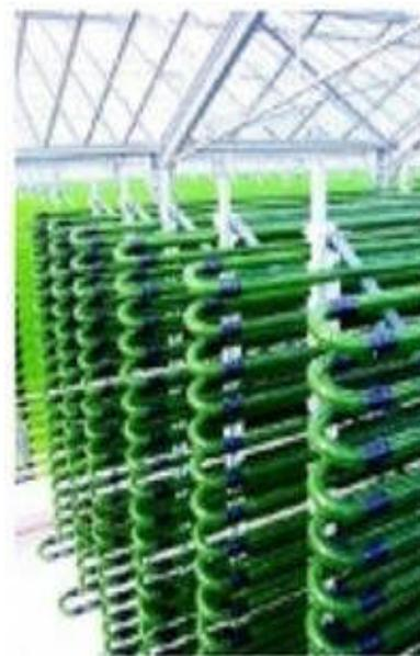
**Figure 7 :** Photobioréacteurs tubulaires et en colonnes
