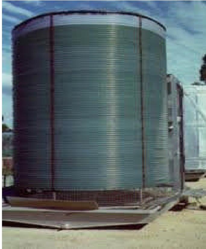
**Figure 5 : Photobioréacteur « Biocoil »**
