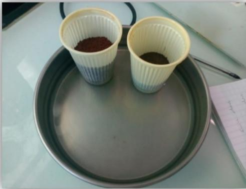
**Figure n° 25** : Saturation des échantillons
