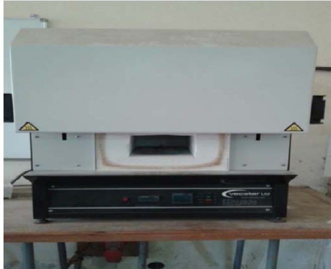
Figure 21 : Four utilisé pour le traitement thermique (Vecstar ltd)
