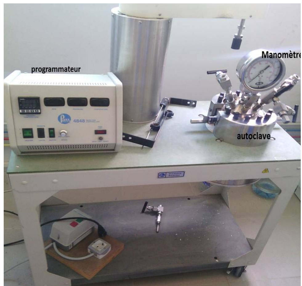
Figure 22 : Le dispositif expérimental utilisé « autoclave » :
