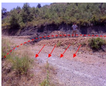
Figure 1.37 : Contour du glissement au niveau de la route
