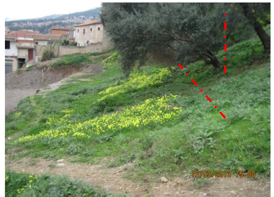
Figures 5.15 Terrassement en aval et Inclinaison des arbres
