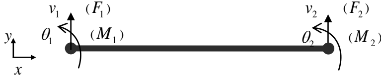
Figure 2.7. Élément poutre à deux nœuds
