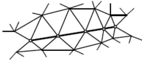
Figure 2.4 : Maillages compatibles sur l'interface
