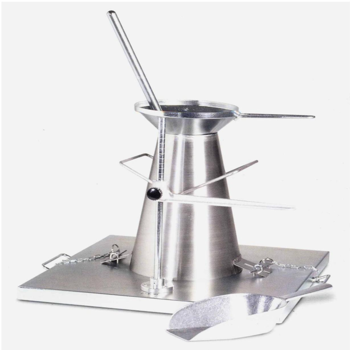
Figure 3.10: Cône d'ABRAMS
