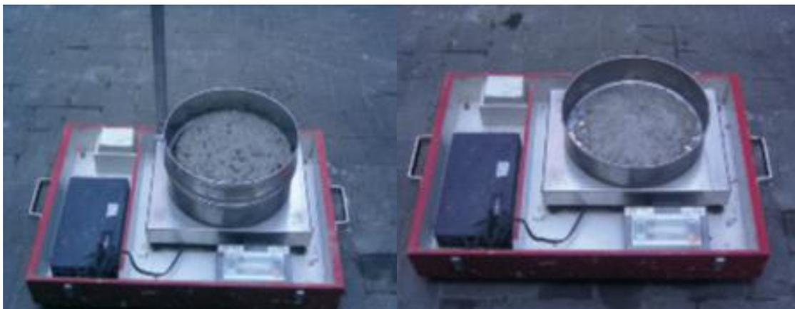
**Figure 3.8 : Essai de stabilité au tamis**
